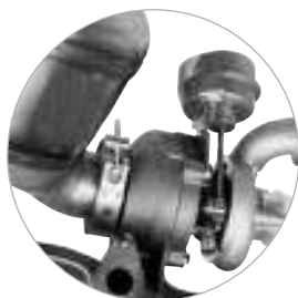
Автомобилестроение: Соединение турбоагрегата – каталитический конвертер
